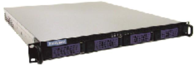
Con cuatro discos Serial ATA (SATA) con tecnología Hot-Plug, el ReadyNAS 1000S es capaz de proporcionar instantáneamente hasta 2.0 terabytes de almacenamiento a un nivel RAID de 0, 1, ó 5. El ReadyNAS 1000S está diseñado para procurar un funcionamiento flexible con plataformas múltiples como Windows, Mac, Linux, Unix, Web browsers y servidores FTP.
