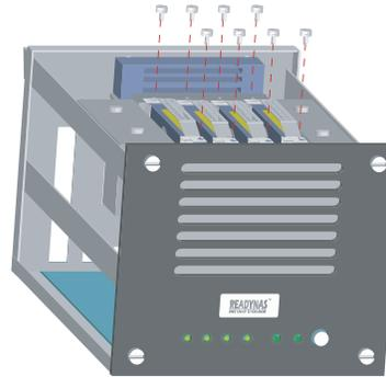
2) Drücken Sie die Platten ganz in die SATA Stecker und sichern die Platten mit den Schrauben.
