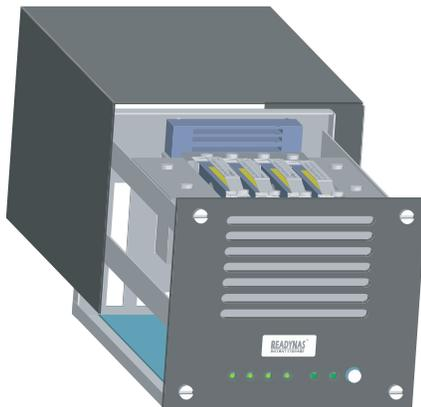
Montiere die Abdeckung und verschraube sie auf der Rückseite.
