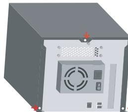
Netz abschalten und 3 Schrauben entfernen.
