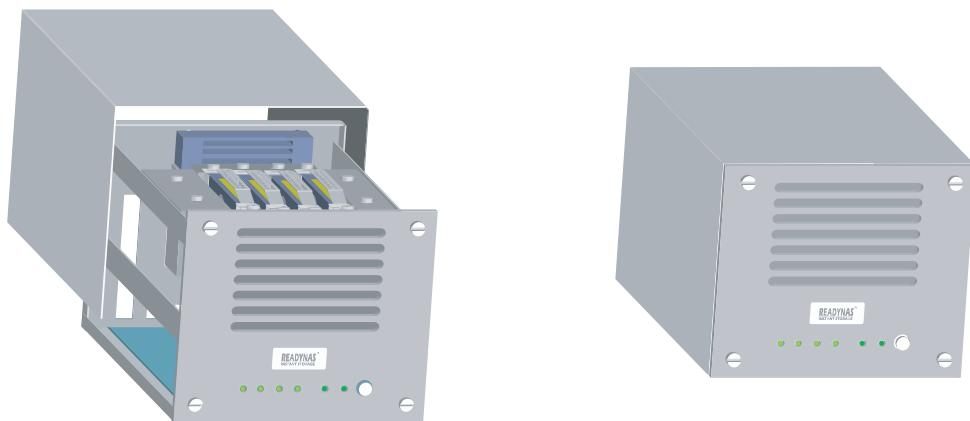
Montiere die Abdeckung und verschraube sie auf der Rückseite.
